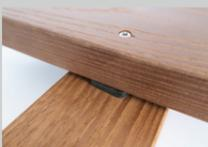
Terrassotec® und Hapatec® sind aus Chromstahl C2 gefertigt und nehmen dank dem erhöhten Ferritanteil Torsionskräfte um bis zu 60 Prozent besser auf als Chromstahl A2 – für einen sicheren Halt. Die Schrauben verfügen über eine Fräsrippe sowie ein hohes Bruchdrehmoment, sind leicht versenkbar und verringern die Wahrscheinlichkeit des Aufspaltens, beziehungsweise der Spanaufstellung (Terrassotec®).
